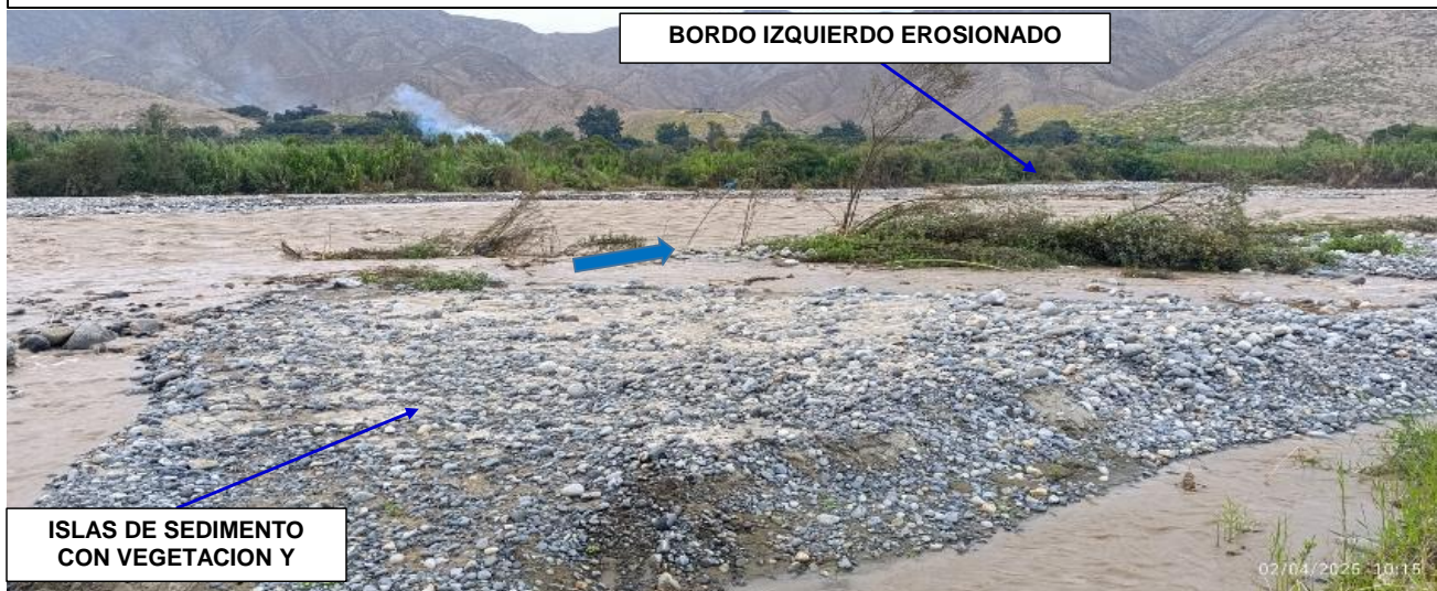
FIGURA N°02: CAUCE DEL RIO CHANCAY-HUARAL, SECTOR LINDEIRO CON EL CAUCE COLMATADO CON VARIAS ISLAS DE SEDIMENTOS E INCLUSO CON VEGETACION QUE DESVIA EL CAUDAL DEL RIO HACIA LOS DIQUES DE AMBOS MARGENES
